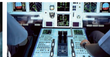
Pedestal 中央操縱台
